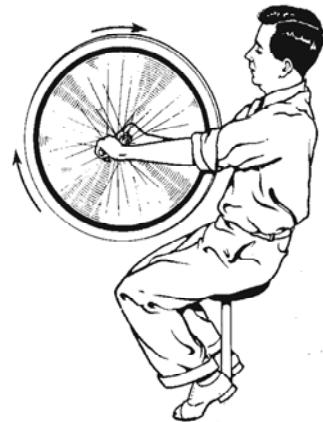
**III pokus :** Objesimo li kotač za kuku na kraju njegove ručke, on će visjeti tako da mu je osovinu u vertikalnom položaju. Ali ako ga prije vješanja dobro zavrtimo, pa ga dok se tako vrti objesimo i pustimo, neće mu osovinu pasti nego će ostati cijelo vrijeme horizontalna. No neće mirovati. Gibati će se u *precesiji* oko niti na kojoj visi. Kako se vrtnja zbog trenja postepeno usporava tako će i osovinu padati naginjući se prema vertikalnom položaju
