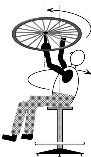
Kotač od bicikla ima po obodu učvršćenu masu koja mu daje veliki moment tromosti. Osovina je produžena na jednu stranu u obliku ručke, tako da se može držati u ruci, a ima i kuku na koju se dade objesiti. Kuglične ležajevе u glavčini treba povremeno podmazati strojnim uljem jer je važno da kotač ima što manje trenje. Kotač služi u pokusima o sačuvanju kutne količine gibanja kada se toj veličini mijenja smjer.
